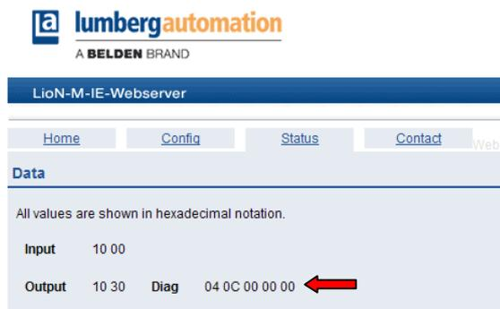
Im Datenbereich der Statusseite werden 5 Bytes Diagnosedaten dargestellt. Die 5 Bytes in der Reihenfolge von links nach rechts sind dabei folgendermaßen aufgebaut:
