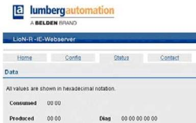
En fonction du module, jusqu'à 5 octets de données de diagnostic sont représentés dans la zone de données de la page de statut. Les octets de diagnostic sont basés sur la structure suivante, de gauche à droite :
