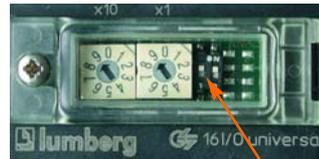
Die Unterspannungsdiagnose der Stromversorgung Aktorik ist über den linken DIP-Schalter abschaltbar.
