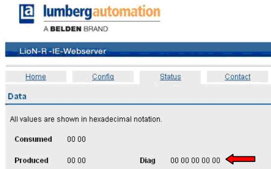
Im Datenbereich der Statusseite werden abhängig vom Modul bis zu 5 Bytes Diagnosedaten dargestellt. Die Diagnosebytes in der Reihenfolge von links nach rechts sind dabei folgendermaßen aufgebaut:
