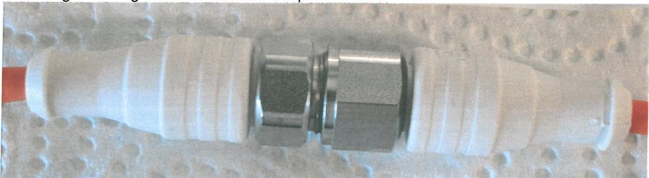
Abbildung 4 Prüfling nach Kontakt mit P3-topax 52
